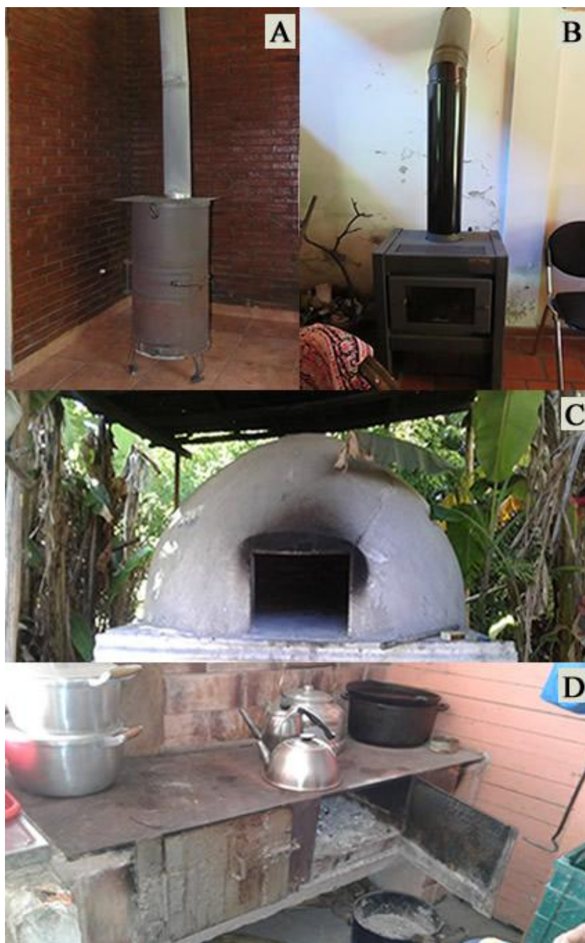
Figura 12. Artefactos empleados: A. Salamandra confeccionada de forma artesanal. B. Salamandra de doble combustión. C. Horno de barro artesanal. D. Cocina a leña artesanal.
