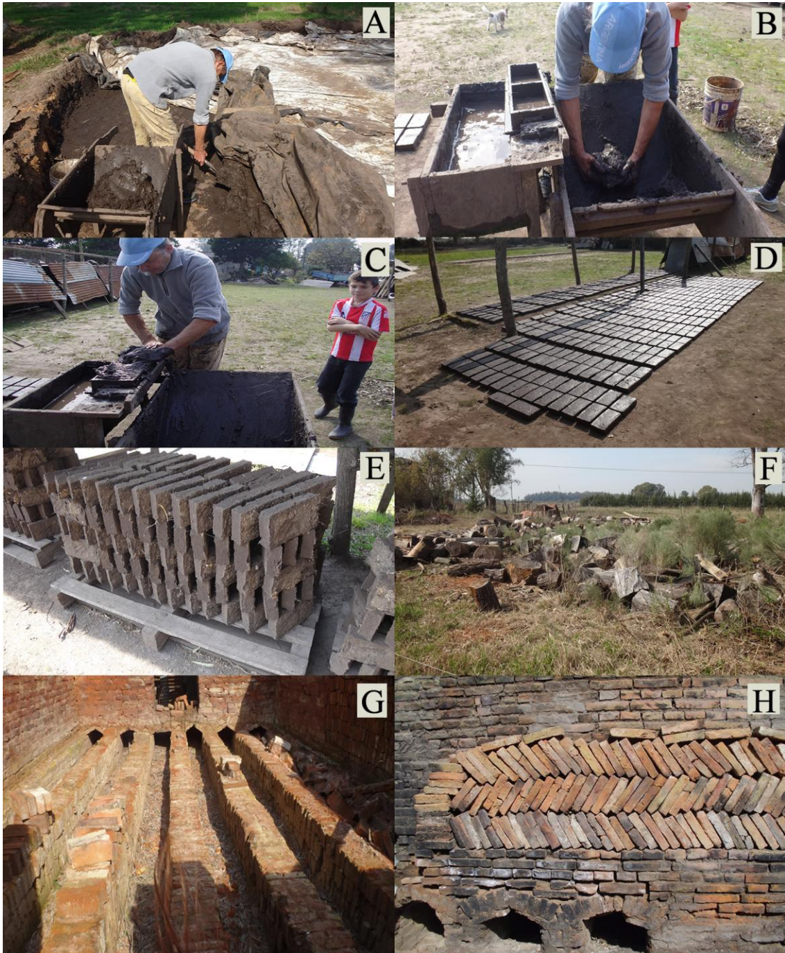
Figura 17. Hornos de ladrillo en Magdalena. A-E. Primera etapa de la confección de los ladrillos. F. Pila de leña para ser usada en el horno. G. Vista interna del horno. H. Vista externa del horno.
